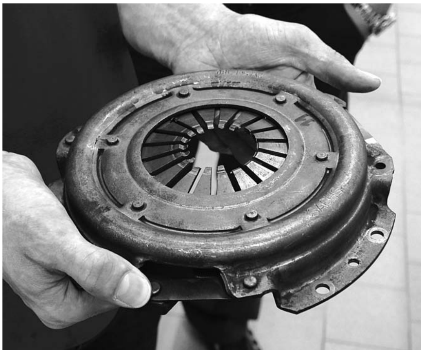
Износ лепестков диафрагменной пружины в результате неправильной установки выжимного подшипника. Причины - ошибка при монтаже, длительная эксплуатация при наличии симптомов неисправности.
