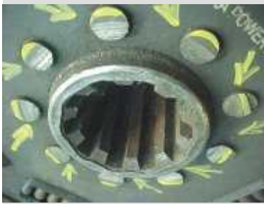
Interferencia del disco de embrague con los bulones del cigüeñal.
