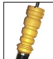
Tope-rebote de amortiguador en buen estado
