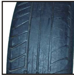
Desgaste del neumático prematuro y desparejo
