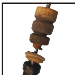
Tope rebote deteriorado
