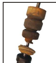
Tope-rebote de amortiguador deteriorado
