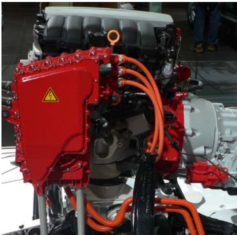
Bild 4: Basisschutz durch Isolation und Abdeckung
