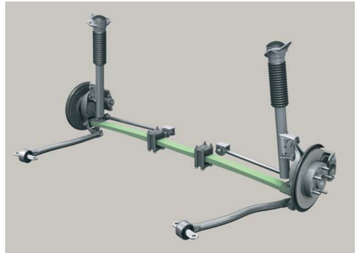
Bild oben: ZF-Hinterachsstudie mit radführender Querblattfeder
