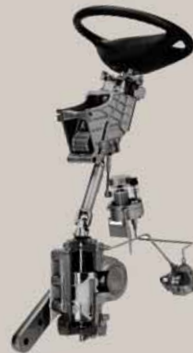
20 Höhenverstellbare und schwenkbare Lenksäule für Nutzfahrzeuge
