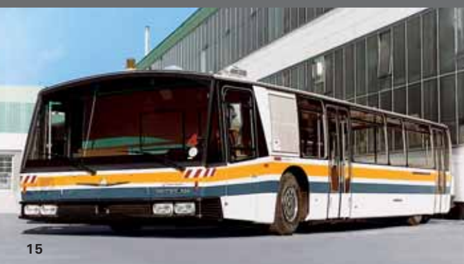
15 Auwärter Flughafenbus N 912 mit ZF-Kugelmutter-Hydraulenkung 8065
