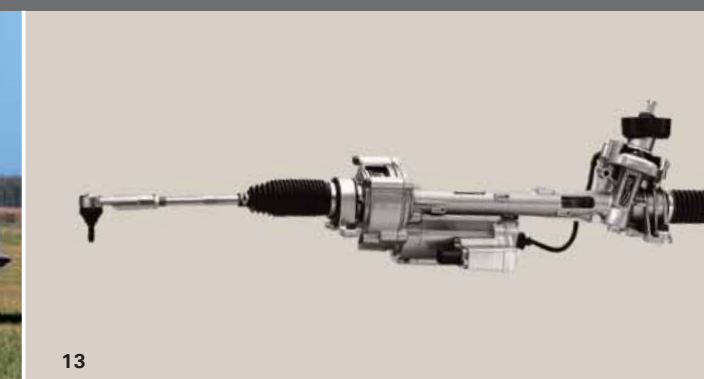
VW Touran etc.): ausgestattet mit der ZF-Servoelectric
