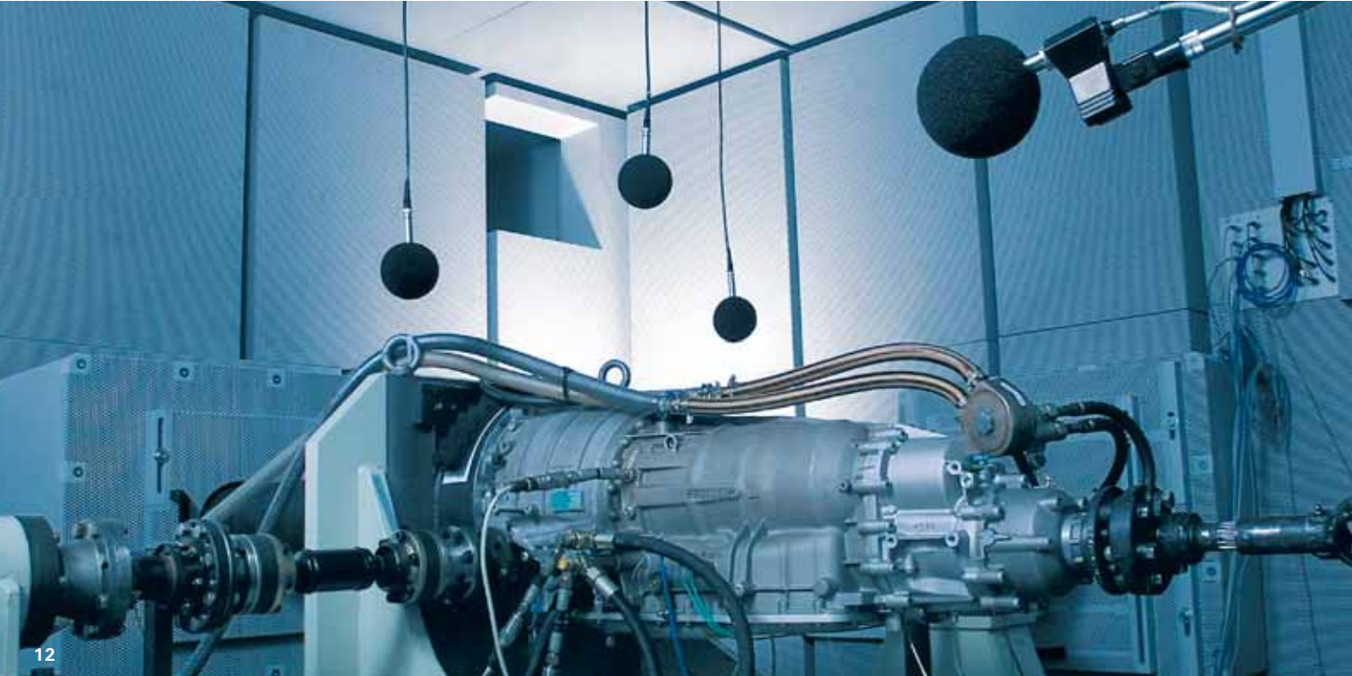
12 Zur Analyse und Vermeidung von Geräuschen im Antriebsstrang nutzt ZF spezielle
