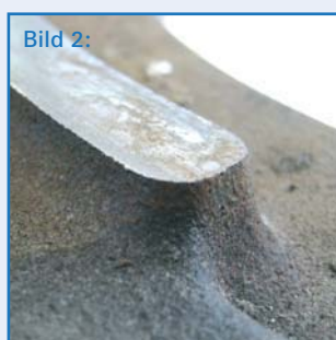
Neue und verschlissene Dachschrägen im Vergleich. Bild 1: Neuzustand Bild 2: Verschleißzustand
