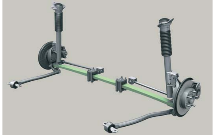
Иллюстрация сверху: концептуальный образец задней подвески ZF с поперечной листовой рессорой.
